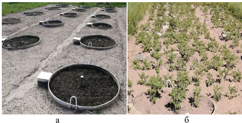
Рисунок 1 - Лизиметрическая станция на дерново-подзолистой почве: а) лизиметры перед посадкой; б) всходы картофеля в лизиметрах
