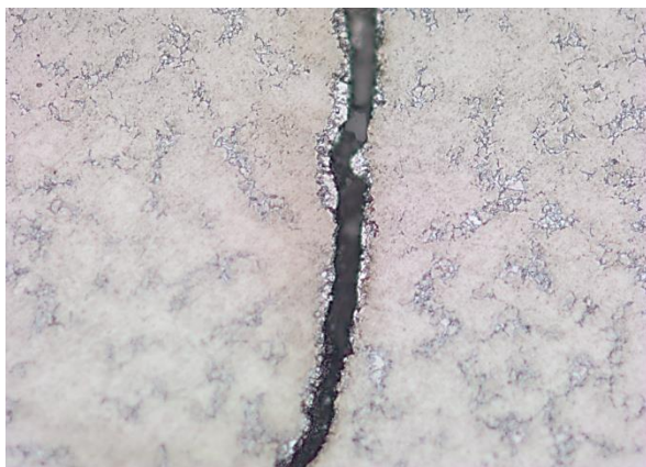
Рисунок 1 – Зона нетравящихся белых полос, окаймляющих «берега» трещины на изделии из стали марки 45 после закалки
