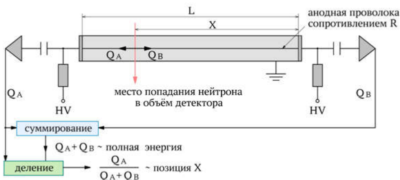
Рисунок 1 – Принципиальная схема определения позиции в линейном позиционно-чувствительном детекторе
