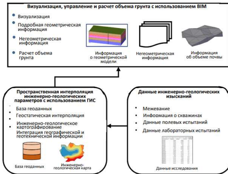
Рисунок 3 – Интеграция BIM/ГИС технологий для моделирования геотехнических свойств и разделения на зоны безопасного строительства [21]
