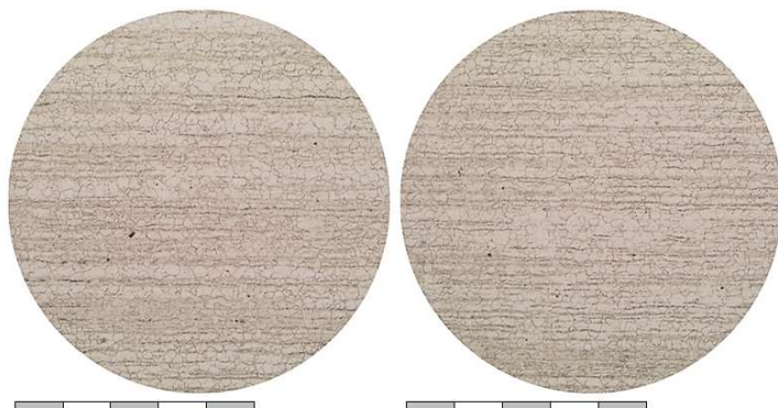
Рисунок 4 – Выявление аустенитного зерна на образцах проката \varnothing 15\text{мм} плавки Б стали марки 16ХСН (режим т/о – закалка 890^{\circ}\text{C} , 1ч, вода)
