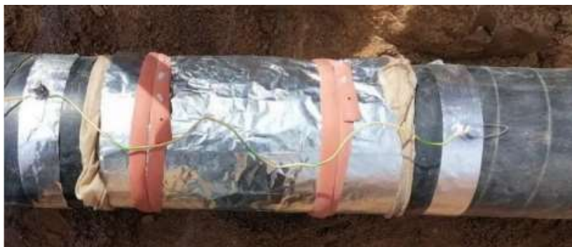
Рисунок 1 – Измерение переходного сопротивления по методике АМИ ГР 0017-2021 УП «МИНГАЗ»
