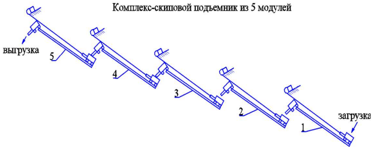
Рисунок 6 – Скиповый подъемник из 5 модулей с длиной каждого по 83 м
