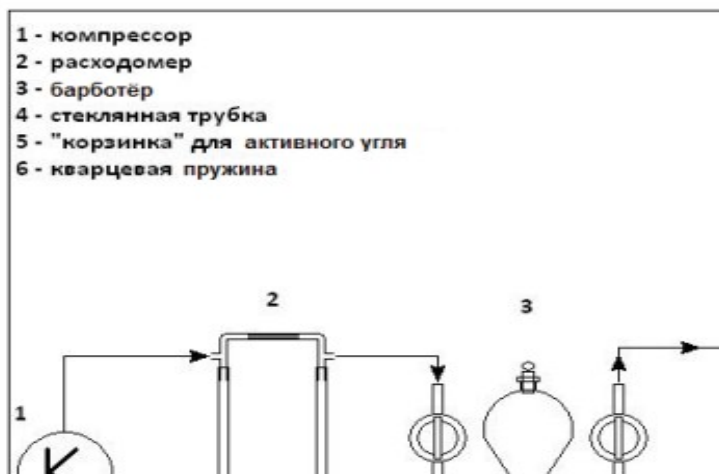
Рисунок 1 – Установка для исследования адсорбции паров бензола из паровоздушной смеси и его десорбции из активного угля
